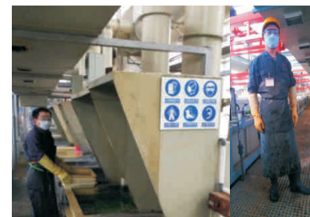
电镀岗位 PPE
